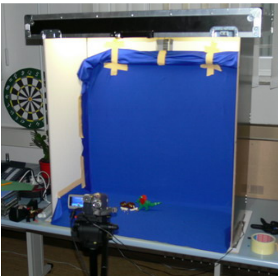
Bild 2.1 fertig aufgebaute „Bluebox“ für eine „3D-Aufnahme“ (versch. Kamerapositionen)
